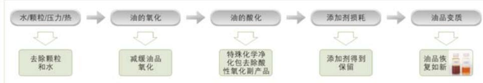
油品在去除水分，颗粒的同时，也去除了氧化酸性副产物，避免了油品的变质，而且油品原有的添加剂得以保留，继续发挥其功能，使得油品可以长时间使用而不需要更换，其核心技术的净化包净化技术可以达到以下效果：
